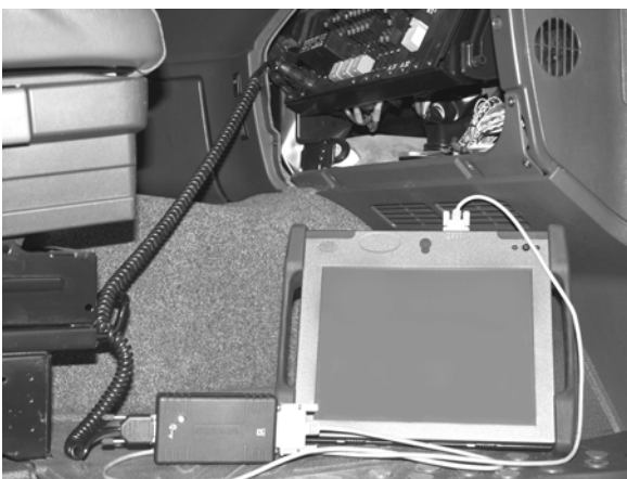
Abb. 39: Diagnoseanschluss über Interface an den Diagnose-PC
